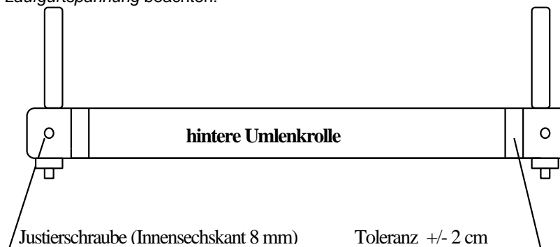
Abbildung 19: Justierschrauben Laufgurt. Bei VENUS® und SATURN® VORNE!
