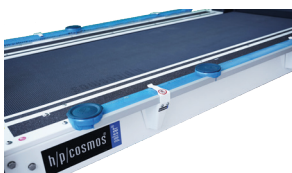
h/p/cosmos speedcontrol [cos101000_speed_control] ermöglicht mittels optometrischem System eine automatische Geschwindigkeits- und Steigungsanpassung je nach Position des Probanden auf dem Laufgurt.
